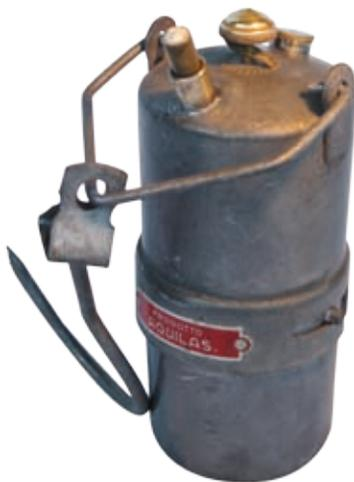
**Fig. 16 Lampada a carburo con chiusura a vite**
