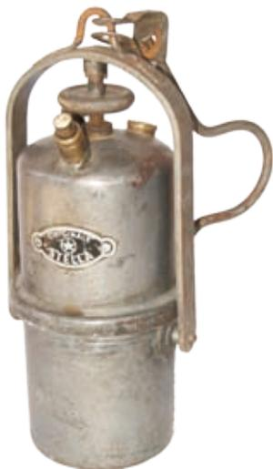
**Fig. 14 Lampada a carburo con chiusura a vite di pressione che preme il serbatoio dell'acqua sul contenitore del carburo**
